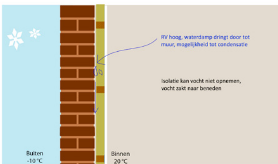
Afbeelding 5A-B Schematische weergave van dampopen isoleren
