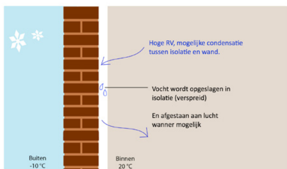
Afbeelding 7A-B Schematische weergave van capillair actief isoleren
