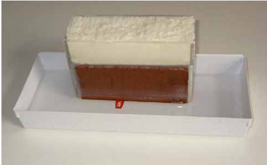
Proefstuk gevuld met PUR-schuim gebruikt bij absorptieproeven
